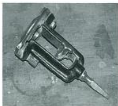
Verktyg för svarvning av eketrapp med hjälp av borrsväng.
