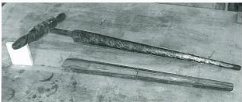
Rörsked med slida för justering av hålet till bössan i hjulets nav.
