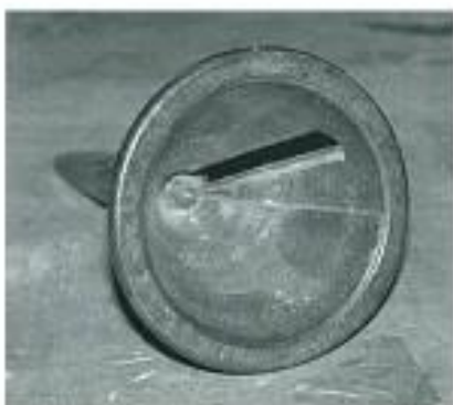
Verktyg för koning av ekertapp med hjälp av borrsväng.
